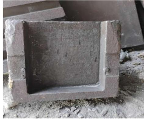
Fig 4: Cast Iron Die Mold
